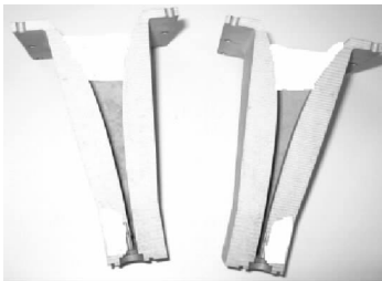
图 4 宽带馈源精密铸件剖切面
